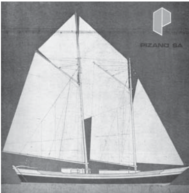
Portada de la Revista Pizano y la Arquitectura 4. Dibujo del alzado de la Tarena. Aparecen el aparejo y el casco por encima del nivel de flotación.
