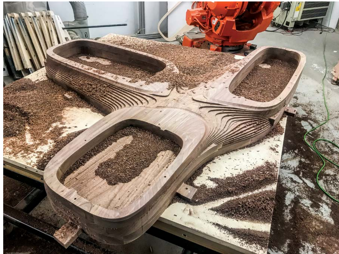
Procesos con robot CNC de 5 brazos / Process with a five-armed CNC robot
