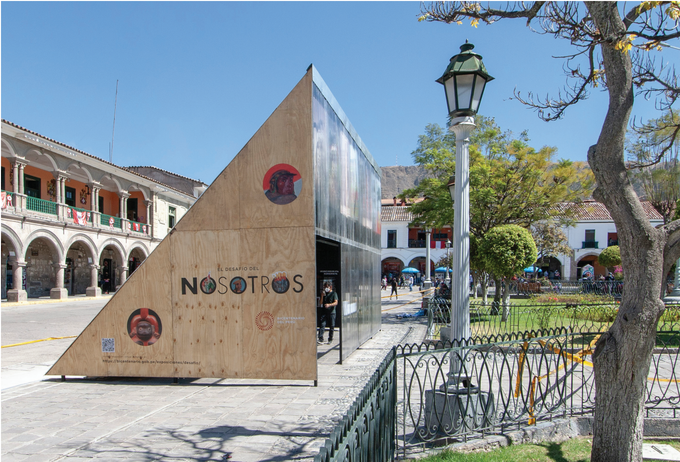
Figura 15_ Los laterales muestran la claridad geométrica y el punto de partida modular: el tablero de madera contrachapada de 1.22x2.44m.
